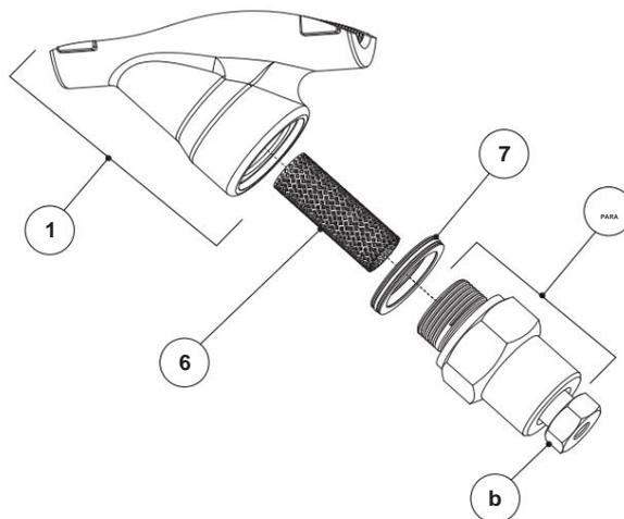
Fig. 5 - Válvula de purga BDV.
