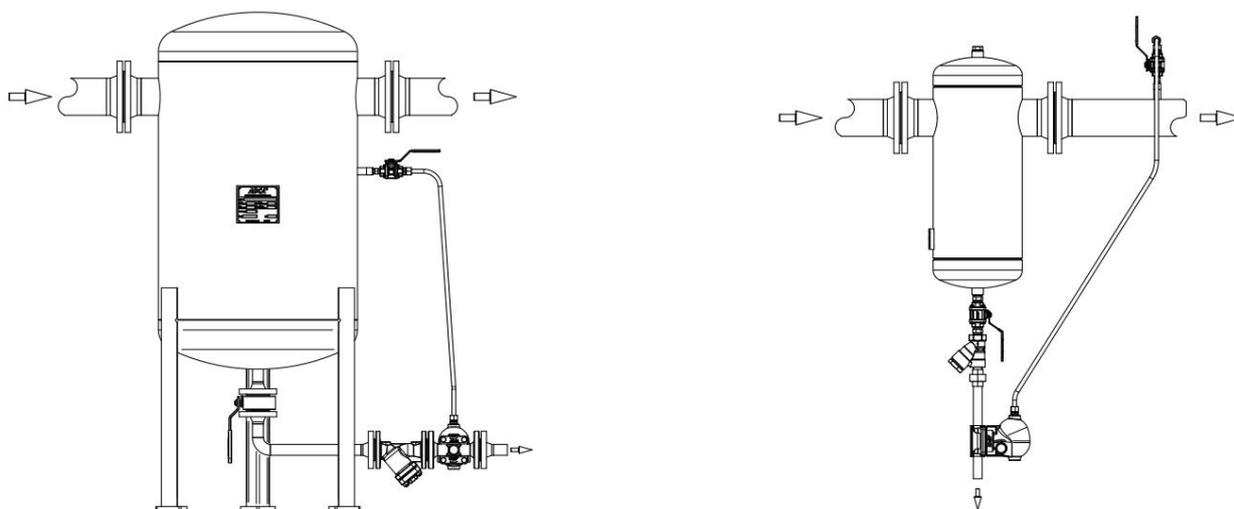
Fig. 2 - Exemplos de disposição de linhas de balanceamento.
