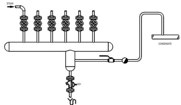
Drenagem de uma tubulação de vapor com condensado elevado Drenagem de uma bolsa de água em planta externa, esta linha. a instalação também evita o congelamento.
