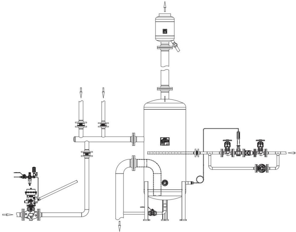
RESFRIAMENTO DE ÁGUA E CONDENSAÇÃO DE VAPOR FLASH COM VÁLVULAS DE CONTROLE PNEUMÁTICAS ADCATROL ON/OFF
